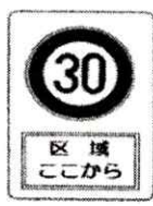
区域規制標識
