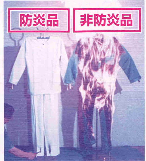
パジャマにライターで着火し燃焼を比較
